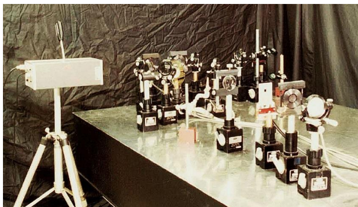
光学定盤上に組んだダイナミックインターフェロメトリー系 1)
