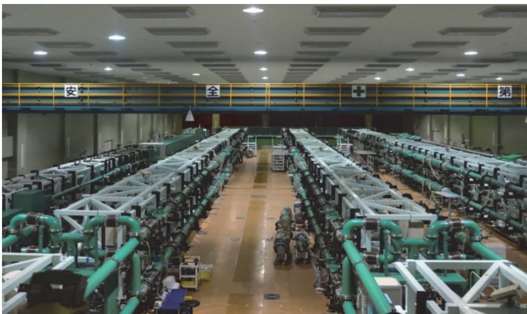
図 2 激光Ⅻ号装置（出力エネルギー20kJ/1ns）
