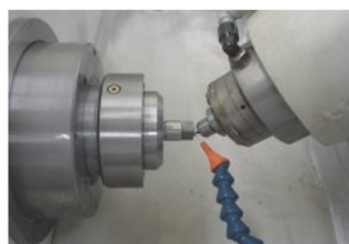
傾斜砥石軸による加工状況
