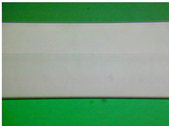
図 10 レーザースクライブで加工されたガラスの分断面
