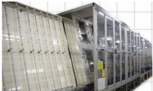
図 9 傾斜搬送方式を用いた大型液晶基板洗浄装置
