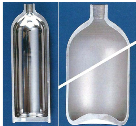
図 16 ECB したボンベと従来のボンベ
