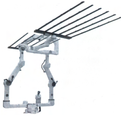
図 13 現地での再組み立てが不要なクリーンロボット
