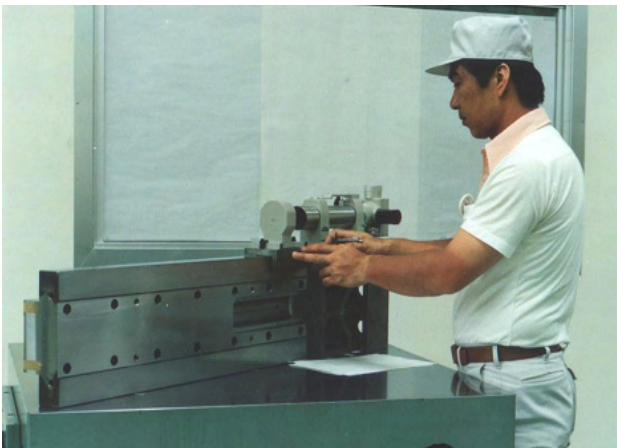
図 11 支持台としての定盤の使い方 (オートコリメータによる真直度の測定)
