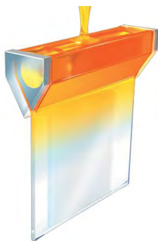
図2 フュージョン法の概念図
