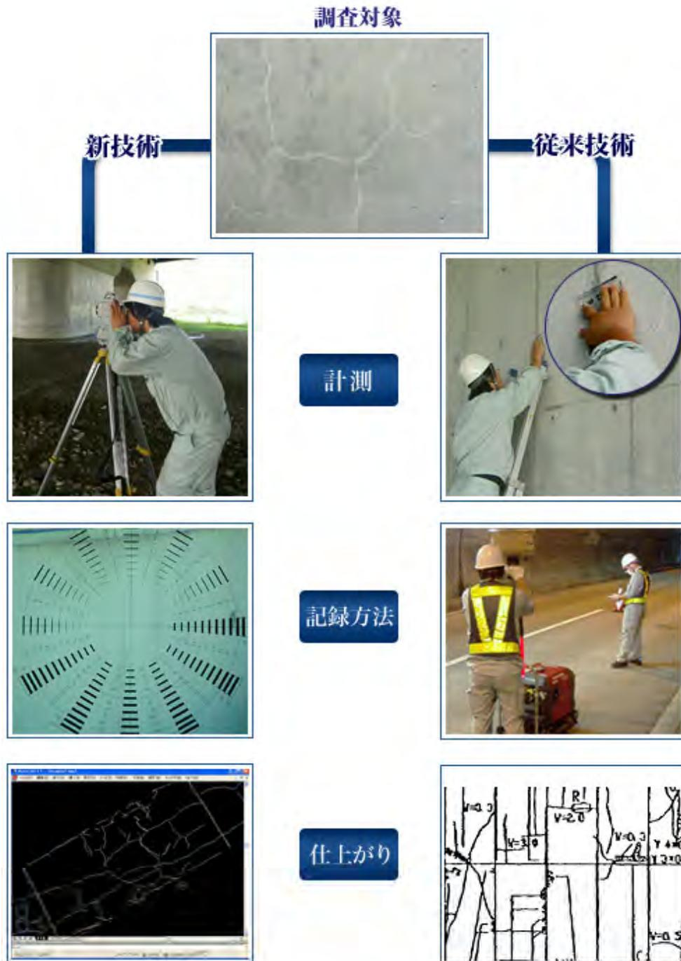
図 8.10 ノンプリズムトータルステーションによる検査と従来法との比較
