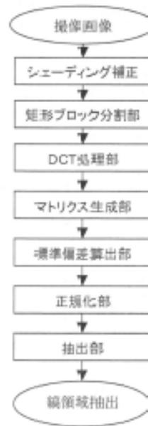
図 3.14 膜厚むら検査アルゴリズム
