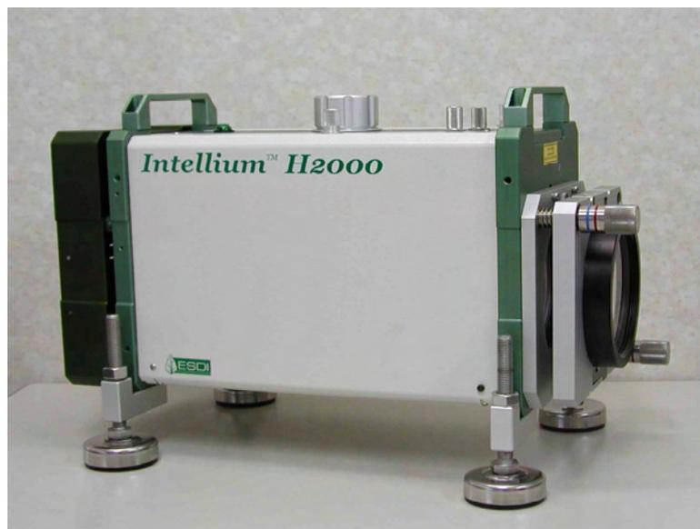
写真 12.4 H-2000 瞬間位相シフトフィゾー干渉計 外観
