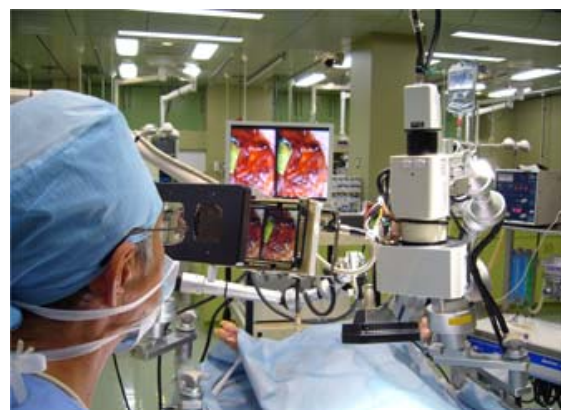
図 3.5-3 試作したビデオ顕微鏡（右）
