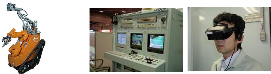
図 2-1 小型軽作業ロボット SWAN と遠隔制御装置（出典：日立製作所ホームページ）
