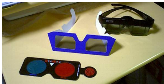
図 2.1-1 立体眼鏡（左からアナグリフ用メガネ、偏光メガネ、時分割式用メガネ）
