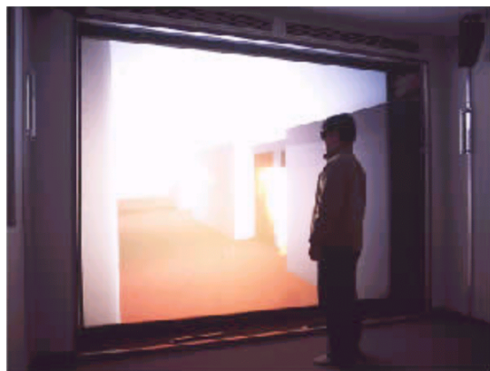
図 4-7 火災疑似体験システム fire cube（消防研究所）
